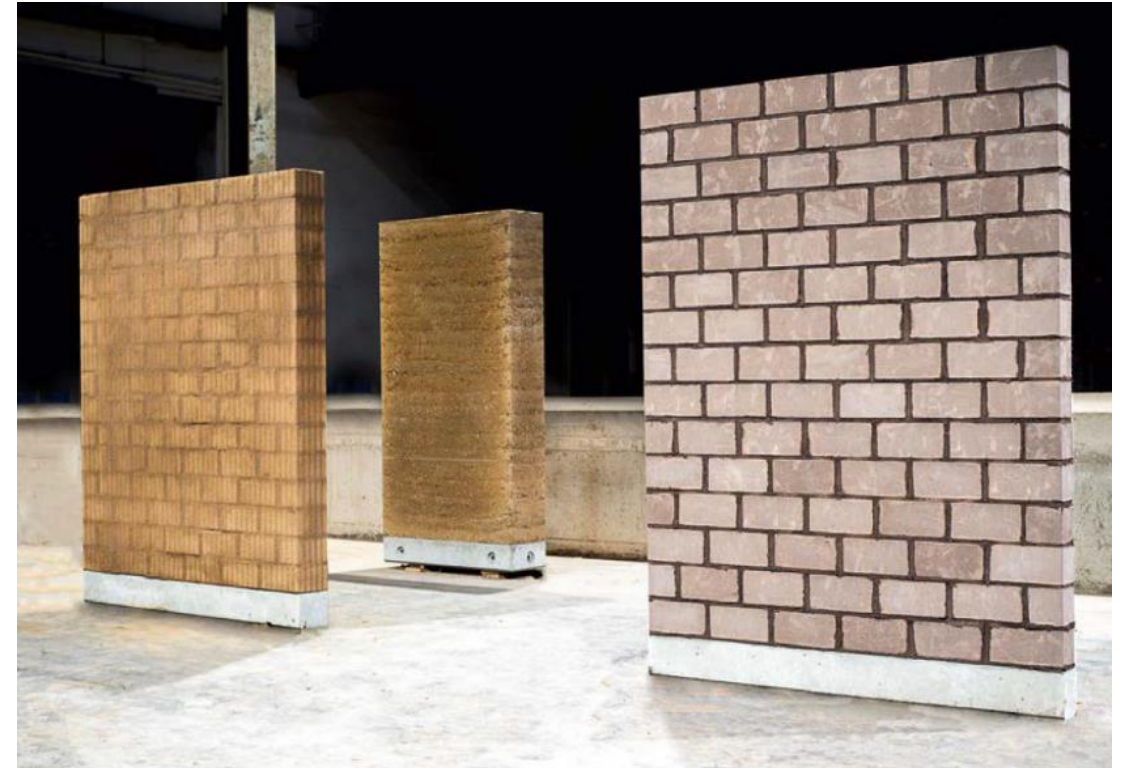
Nichttragende Innenwände aus Lehmsteinen
