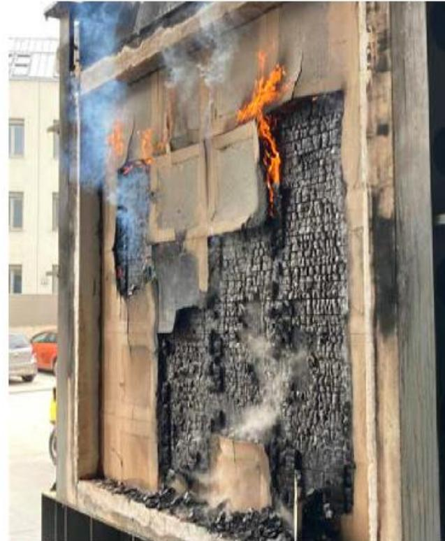
Brandversuch der Brettsperrholzwand mit Lehmputzplatte nach 95 Prüfminuten (links)
